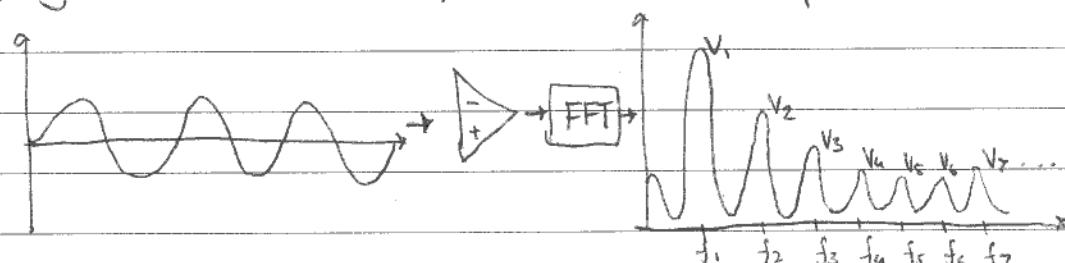
$$THD = \sqrt{V_2^2 + V_3^2 + V_4^2 \dots} / V_1 \quad \%$$
